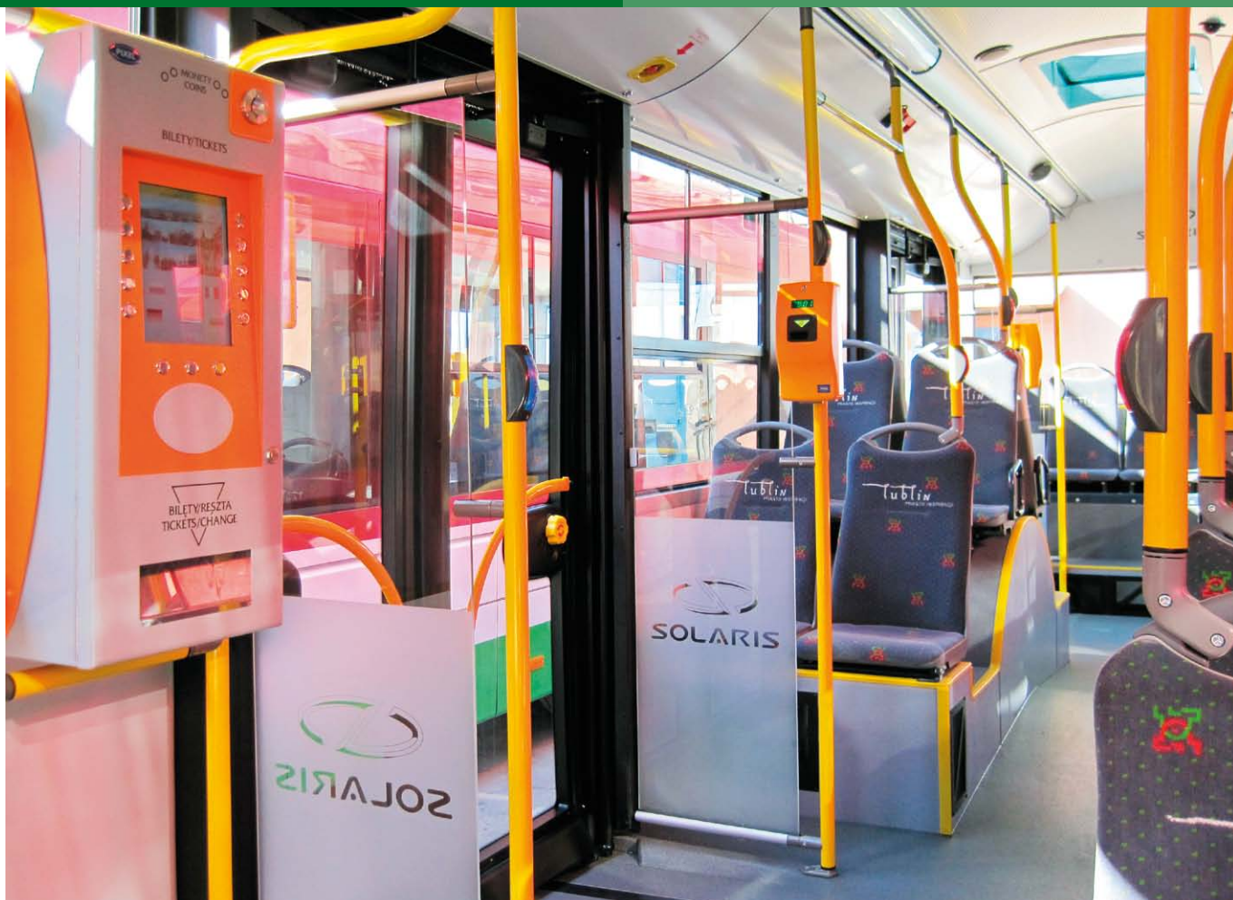
Komfortowo wyposażone wnętrze trolejbusu: miękka tapicerka, „ciepły guzik”, głosowa zapowiedź przystanków, wielojęzyczny biletomat. Brakuje tylko klimatyzacji
